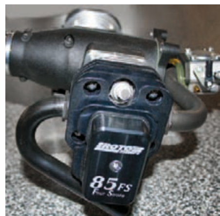
Die Ventile sind durch einen Deckel geschützt – so bleibt auch das Innere der Haube sauber.
