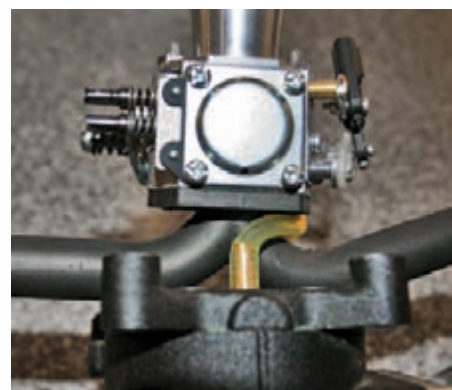
Der Vergaser sitzt zentral auf einem Flansch der zusammengeführten Einlassrohre.
