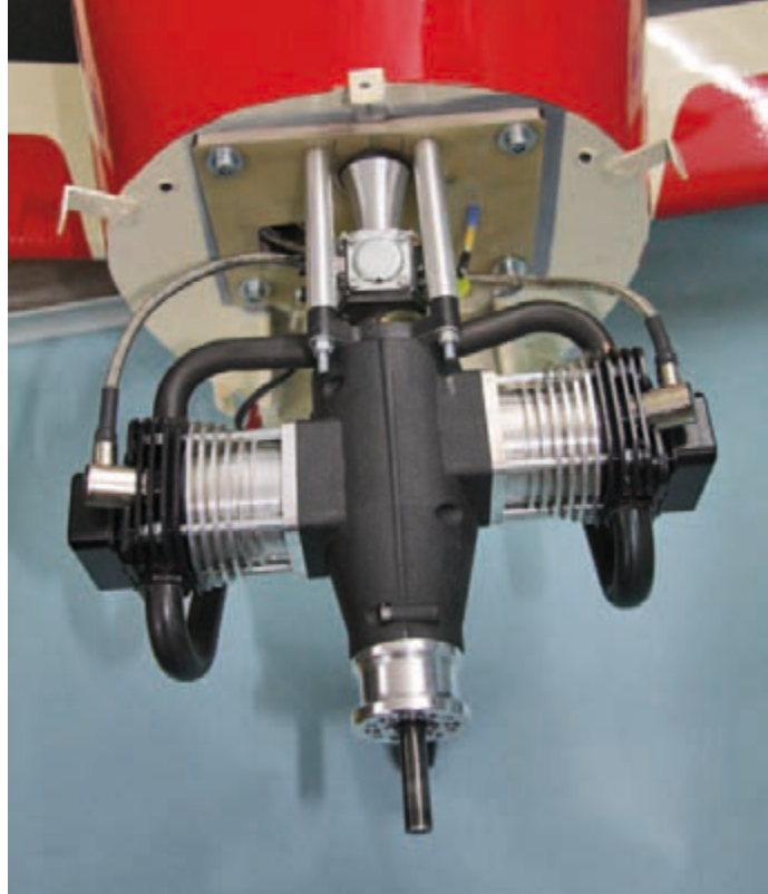
Der RM 85 FS sitzt bereits an seinem zukünftigen Arbeitsplatz. Die Montage im Modell erfolgt hier auf Stehbolzen – denkbar wäre auch ein zusätzlicher Montagespant, dann könnten die Stehbolzen mit einem größeren Abstand montiert werden.
