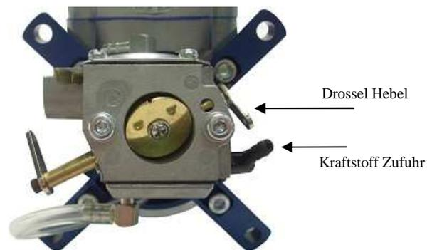
Vorsicht! Die Düsennadeln nicht überdrehen, sonst könnte der Düsenstock beschädigt werden!
