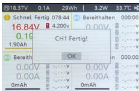
Der Ladevorgang ist beendet, der Akku ist voll aufgeladen und gut balanciert
